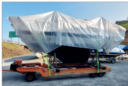
Zwei Bügel aus Alurohr bilden das Gerüst für die Winterpersenning.
